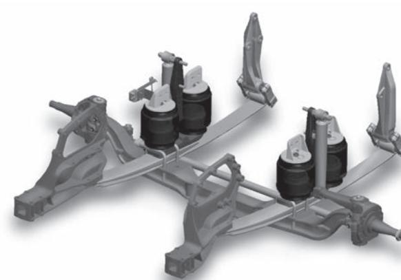
**La Suspensión Delantera de Aire AG130**, mejora la calidad de manejo en un 20% comparada contra las suspensiones mecánicas y soporta 75% de la carga vertical en sus bolsas de aire para un mejor manejo del T800.
