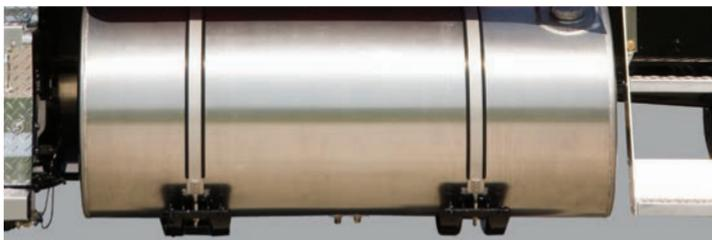
*Los tanques de combustible de aluminio son más seguros y resistentes, cuentan con tapón con llave de seguridad y sistema antisifón.*
