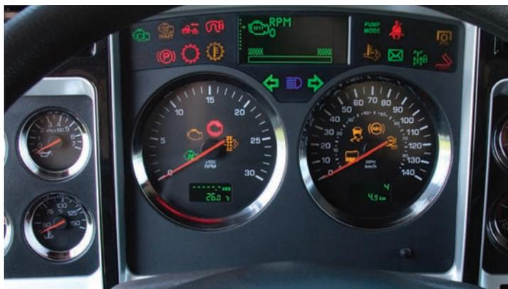
*La pantalla multifuncional permite al operador vigilar la condición de luces y conexiones con el remolque, así como, del arranque motor.*
